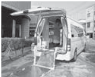
▲後部には車いす用リフトが設置されています
