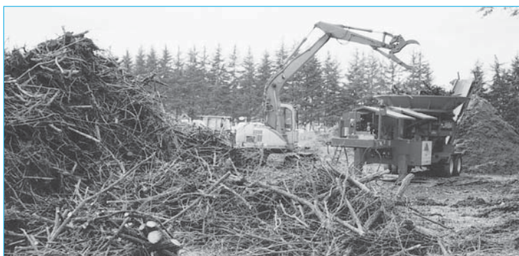
▲たい肥の原料として利用するため3,000本の原種木すべてをせん定し行った木材のチップ化作業(10月27日~31日/原蚕の杜)
